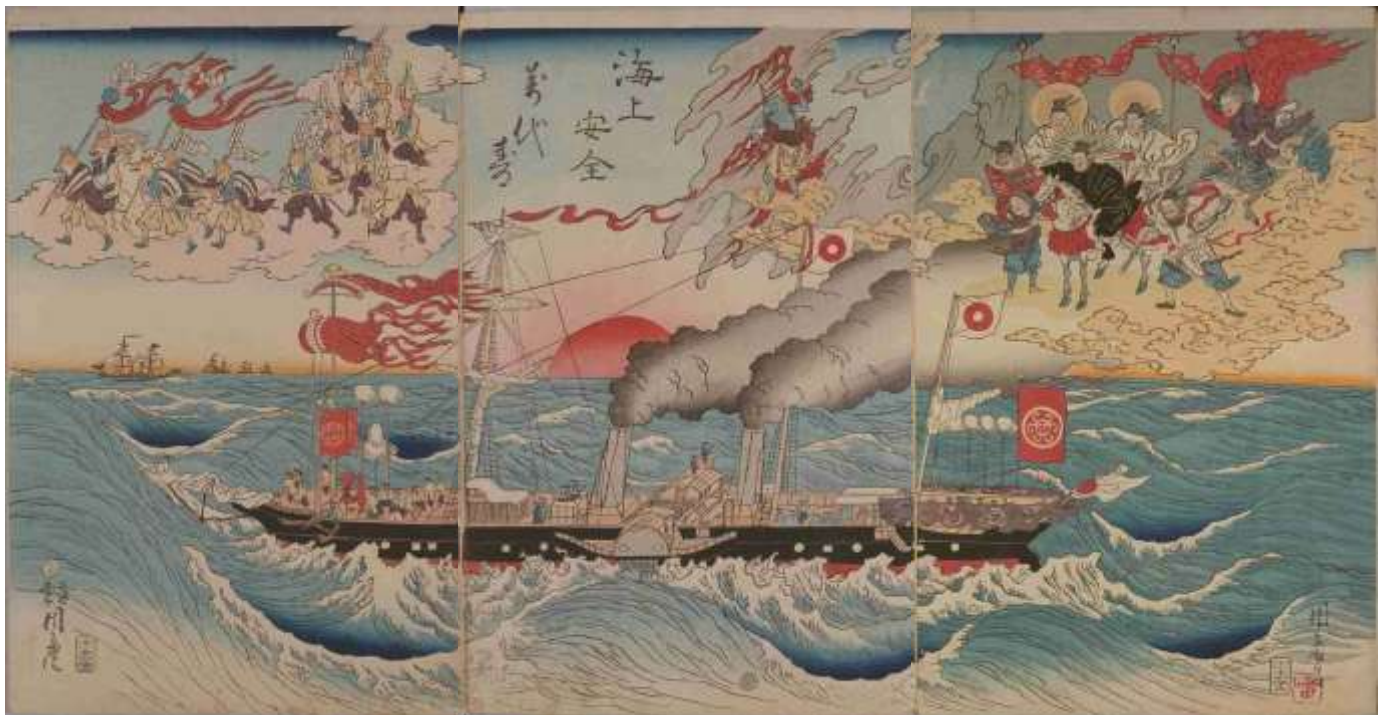
「海上安全万代寿」文久3年 周磨画(早稲田大学図書館蔵) 転載不可 将軍徳川家茂を乗せて航行する順動丸を描いた錦絵。作者周磨はのちの河鍋暁斎。 全長約73m、船体幅約8m、吃水約5m、排水量405トン、360馬力
