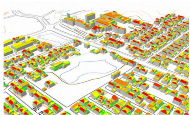
図 3D都市モデルを活用した太陽光発電のポテンシャル推計及び反射シミュレーションイメージ
