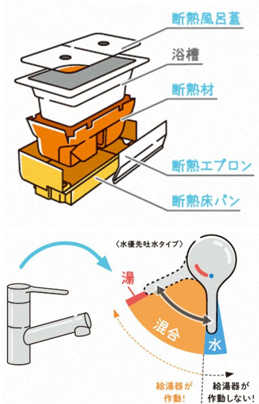
図 高断熱浴槽(上)、節水・節湯水栓(下) 出典:省エネリフォーム紹介 BOOK(環境省)
