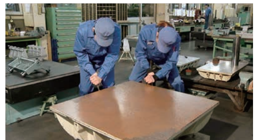
高度な機械加工と伝統の職人技が光る 長岡のものづくり技術 (機械ではできない超精密な平面の仕上げ)
