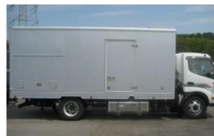
可搬型代替交流電源設備
