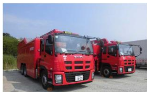
大容量送水車(原子炉建屋放水設備用)
