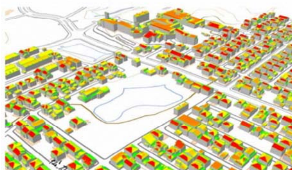
図 3D都市モデルを活用した太陽光発電のポテンシャル推計及び反射シミュレーションイメージ
