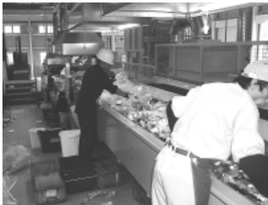
「プラスチック容器包装材」に混入した異物は、手作業で取り除かなければなりません。
