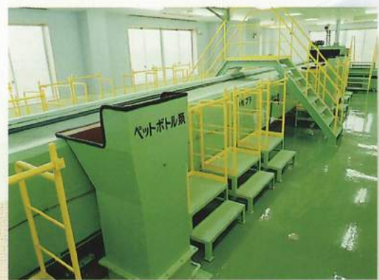
●手選別コンベヤ 人の手によってペットボトル、カレット等を選別します。
