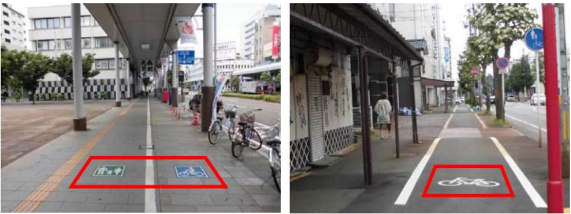
図 歩道内での自転車と歩行者の通行位置の明示（大手通り、城内通り）
