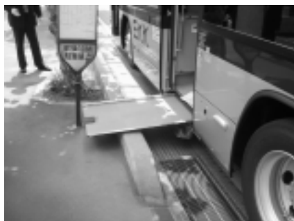
ノンステップバスと歩道の段差 歩道によってはノンステップバスのスロープと高さが合わない。
