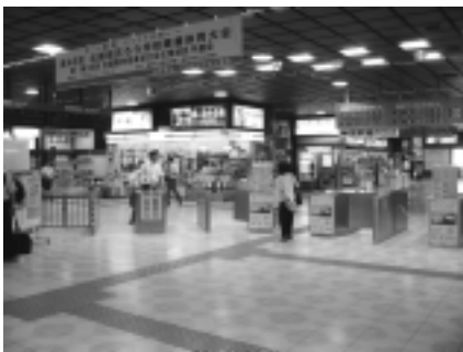
在来線改札 幅員 80cm のため、車いす使用者の操作する手が改札に当たることが懸念される。
