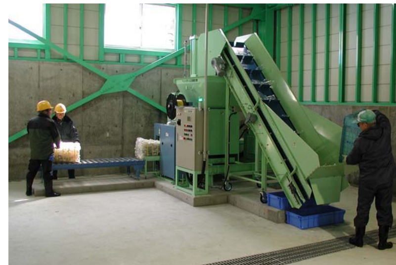
ペットボトルを入れると圧縮から梱包まで自動で行うペットボトル圧縮梱包機
