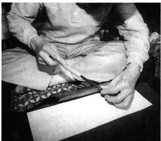
切れ味の決め手、ヒズミ取りの作業をする「中屋幸四郎」こと、榊沢幸雄さん（脇野町）。京都在住の数寄屋大工が中屋幸四郎作の手引鋸を、生涯使える本鋸として推せんしたことにより、週刊ポスト紙面に登場しました。
