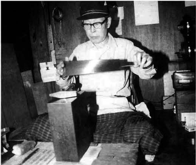
切れ味の決め手、ヒズミ取りの作業をする「中屋幸四郎」こと、榊沢幸雄さん（脇野町）。京都在住の数寄屋大工が中屋幸四郎作の手引鋸を、生涯使える本鋸として推せんしたことにより、週刊ポスト紙面に登場しました。
